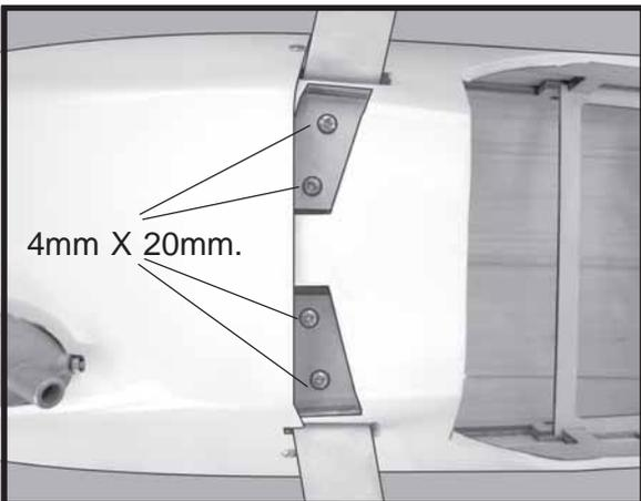
**ELEVATOR - RUDDER SERVO INSTALLATION.**
