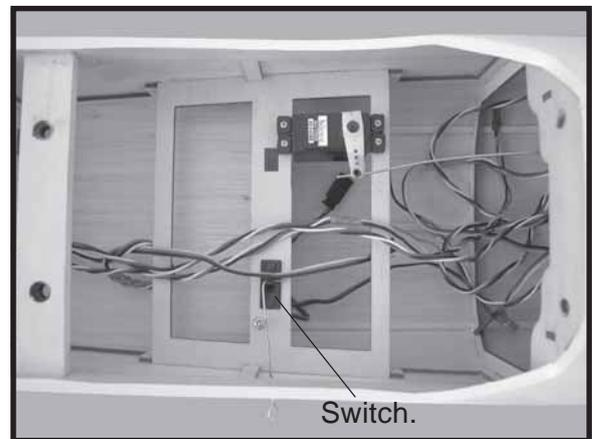
**INSTALLING THE RECEIVER AND BATTERY.**
